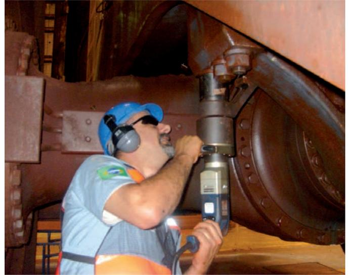
Ab Baugröße LDE-70 werden die Hochmomentschrauber mit einem drehbaren Haltegriff geliefert, um die einfache Bedienung des Geräts zu gewährleisten.
